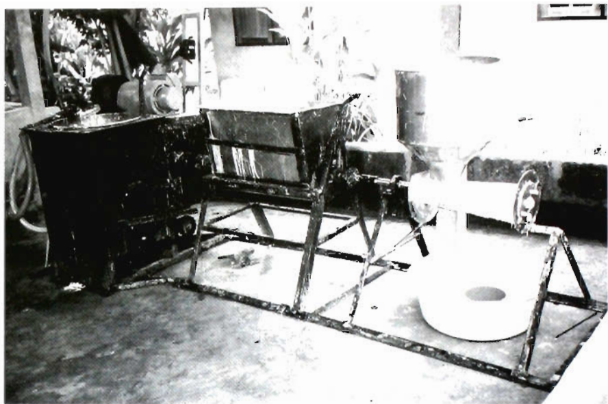
เครื่องทำนมจืดไอเทครุ่นแรกที่ได้ให้การนำไปใช้งานจริงกับชาวบ้านจำนวน 5 หมู่บ้าน ที่บ้านโนนจาน ตำบลโนนสง่า อำเภอปทุมรัตน์ จังหวัดร้อยเอ็ด
