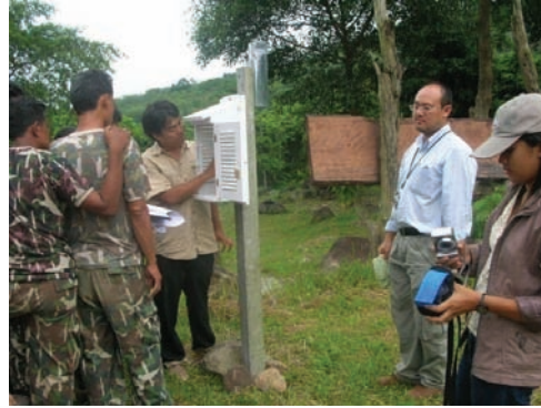
▲ การติดตั้งสถานีตรวจวัดอากาศในป่าเมฆเพื่อติดตามการเปลี่ยนแปลงของสภาพอากาศ
