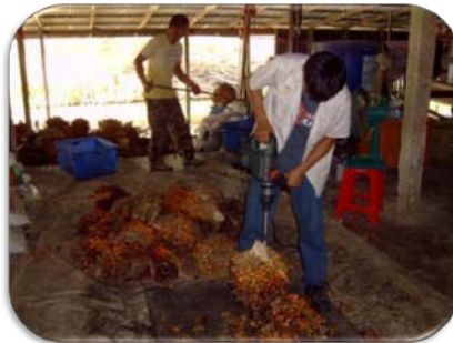
ใช้เครื่องแยกและ แรงงานคนในการ แยกผลปาล์มจาก ทะลาย
